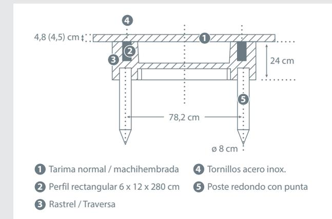
Los rastreles deben instalarse en la superficie con una distancia entre sí de aprox. 1,40 m. Para nivelar el terreno se pueden utilizar primeramente postes redondos enterrados donde se apoyarán los rastreles. Luego se colocarán las tablas correspondientes atornilladas a la subestructura.
