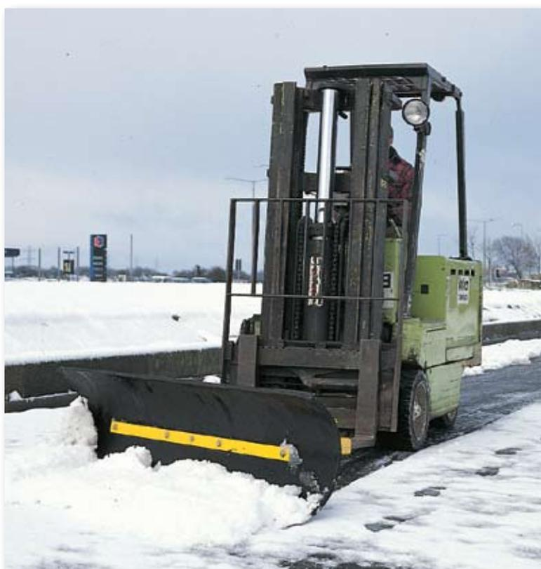
La carretilla elevadora que están utilizando puede ser convertida en una potente y eficiente máquina quitanieves. La pala Snowdozer de Glasdon es un complemento de muy fácil instalación. Proceda a insertar las horquillas de la elevadora y asegure los pernos sin necesidad de herramientas. Retirar nieve será una labor más fácil y rápida este invierno. La pala curva de polietileno de 15mm de grosor ofrece resistencia adicional y al ser reversible, su vida útil se duplica.
