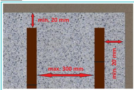
Coloque los componentes de la subestructura por su lado plano (no de canto) a una distancia entre ellos de 300 mm como máximo.
