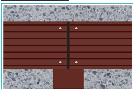
A continuación se atornillan las tarimas a la subestructura mediante tornillos inoxidables para madera (por ejemplo: torx, V2A, 4.5 x 60 mm). Se recomienda preagujerear las tablas y el avellanado para la cabeza del tornillo.
