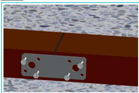
Unir los perfiles de la subestructura mediante pletinas de metal por ambos lados. La subestructura debe atornillarse al suelo por uno de los extremos.
