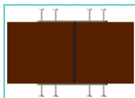
La subestructura debe dividirse en módulos que no sean mayores a 6.0 m x 6.0 m. Siempre dejar una distancia de dilatación entre cada módulo.
