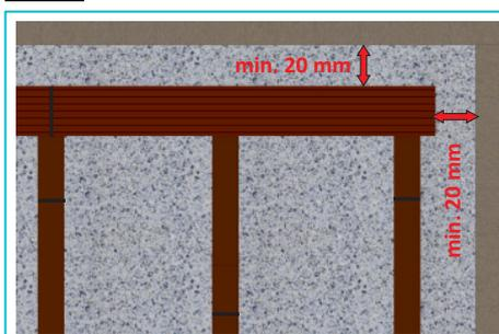
Coloque la primera línea de tarimas sobre la subestructura. Siempre tener en cuenta de dejar como mínimo una distancia de 20 mm entre la tarima y los límites existentes (pared, cerramiento, etc.)
