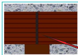
El solapado de las tarimas sobre la subestructura no debe superar los 20 mm.
