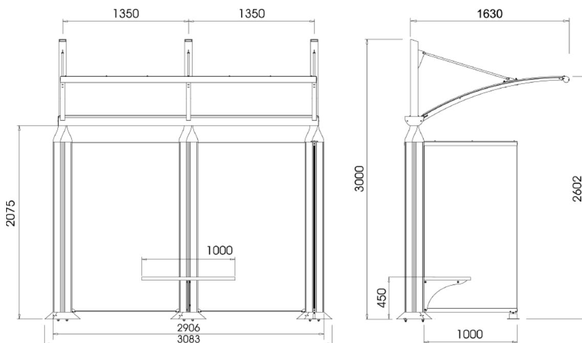
Dimensiones: Longitud 3083 mm – Alto total 3000 mm – Ancho 1630 mm.
